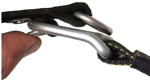
Mittlerer E-Drop, bei dem der größere Kraftübertragungs-Ring übersprungen wurde = Mindest- und Maximal-Last wie beim kleinen E-Drop.
