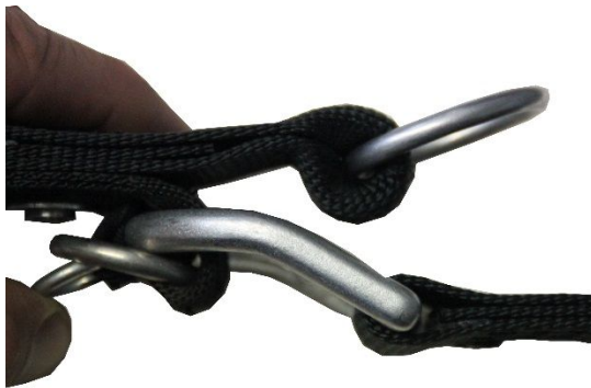
Großer E-Drop, bei dem der größere Kraftübertragungs-Ring übersprungen wurde = Mindest- und Maximal-Last wie beim mittleren E-Drop.
